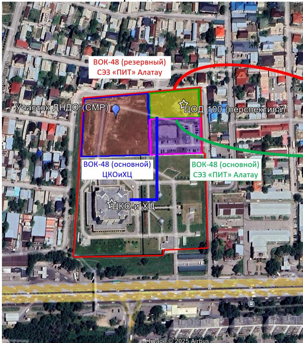
\*Точный маршрут прокладки ВОК-48 G.652 определить в рамках разработки ТЭО. Предусмотреть строительство телефонной канализации до здания ЦКОиХЦ НБ РК, расположенного в г. Алматы, пр.Райымбека 511. Учесть существующие кабеля ВОК.
